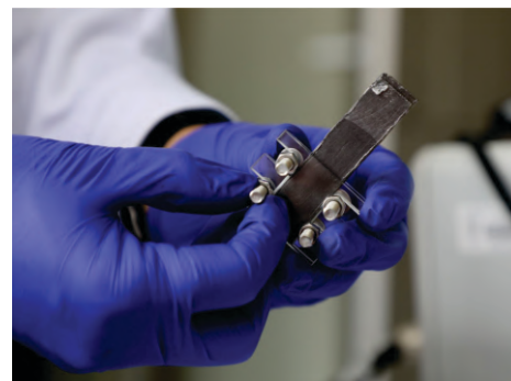
Dispositivo utiliza como colectores de corriente placas de grafito, sobre las cuales se deposita el material activo.
