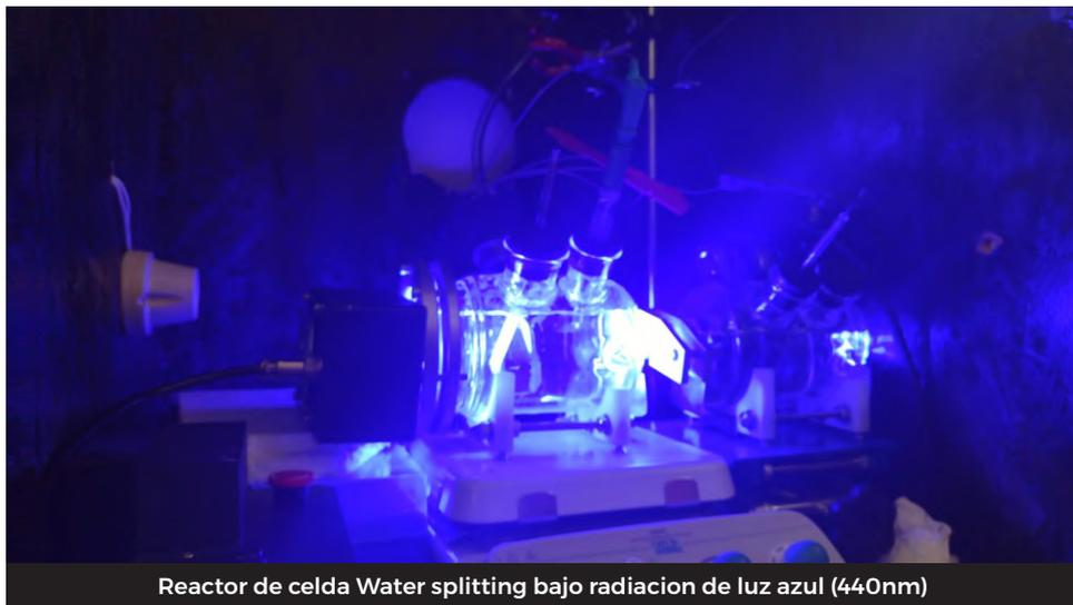
Reactor de celda Water splitting bajo radiación de luz azul (440nm)
