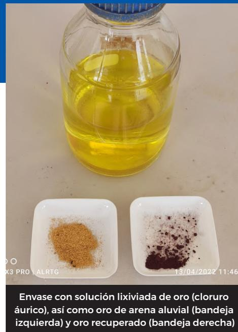
Envase con solución lixiviada de oro (cloruro áurico), así como oro de arena aluvial (bandeja izquierda) y oro recuperado (bandeja derecha)
