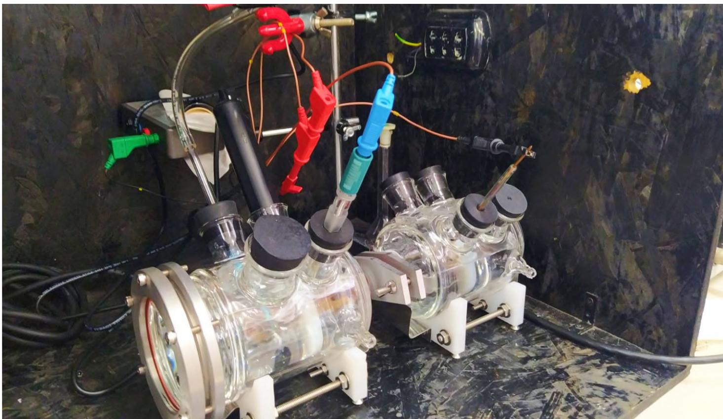
Reactor fotoelectrocatalítico, diseñado y fabricado por el grupo de investigación GISMA
