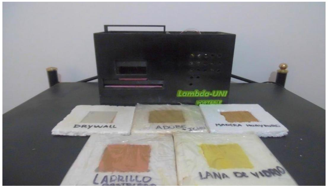
Muestras de los materiales de construcción que se han usado para medir la conductividad térmica
