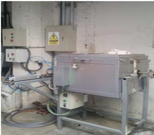
**Figura 6. Vista del Reactor HEVA Piloto de flujo semicontinuo (7 Kg capacidad)**
