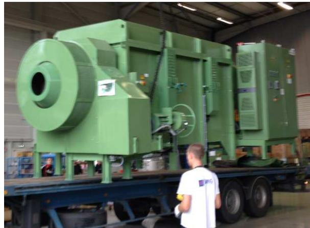
**Figura 7. Vista de un Reactor HEVA de Flujo continuo de 30 T/d de capacidad**
