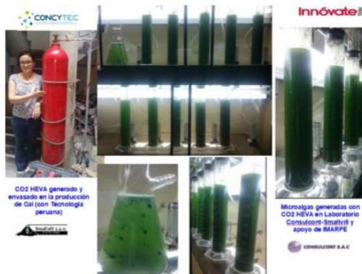
Cultivos de Microalgas en el Laboratorio de SMALLVILL utilizando el CO<sub>2</sub> obtenido en el proceso especial de Calcinación y producción de Cal.
